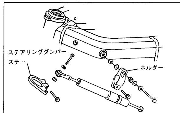
⑥ ステアリングダンパーにホルダーを取り付けてからフレームボデーに取り付ける。
